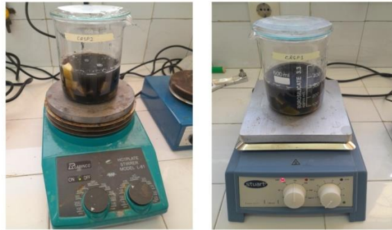
Figure 19 : Préparation du milieu PDA dans 200 ml des solutions CRSP1 et CRSP2.
